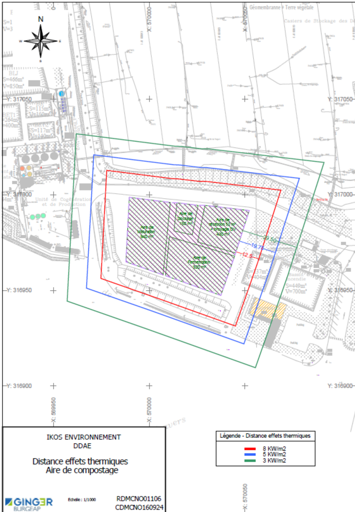
Figure 16 : Effets de thermique issus de l'incendie de la plateforme de compostage à hauteur d'homme
